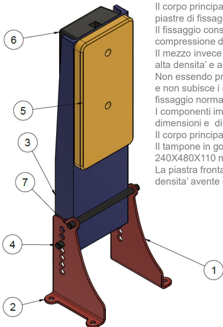
Il tampone si caratterizza per essere fissato solo a terra tramite le piastre 1 e 2 o con altra tipologia di piastra.
