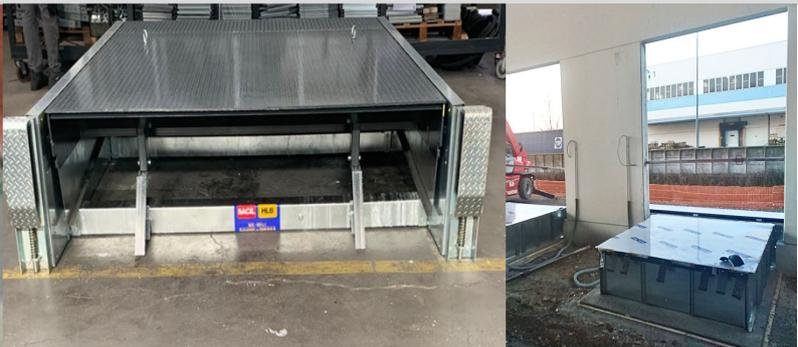
La pedana viene fornita assemblata nella propria cassaforma con impianto elettrico e idraulico collegati. Deve semplicemente essere appoggiata, messa in bolla, stabilizzata e gettata. Tempo di esecuzione ca. 30'.
